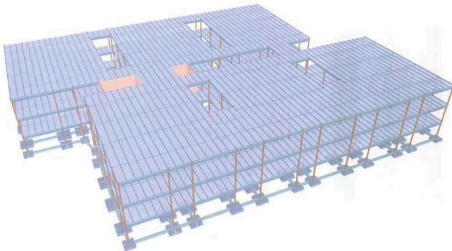
El Sistema Modular Prefabricado Fenobelton se caracteriza por ser una construcción a base de perfiles laminados de acero galvanizado y paneles fenólicos aligerados y con cubierta soportada por una estructura metálica ligera autoventilada.
